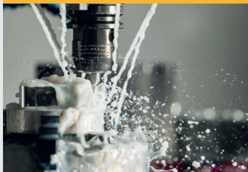
2023 wurde der Maschinenpark um eine Hurco VMX 10i 3-Achs-Fräsmaschine erweitert. Hiermit sind wir in der Lage kleine und mittelgroße Werkstücke im Verfahrensweg 600 x 400 x 500 mm präzise zu fräsen.
