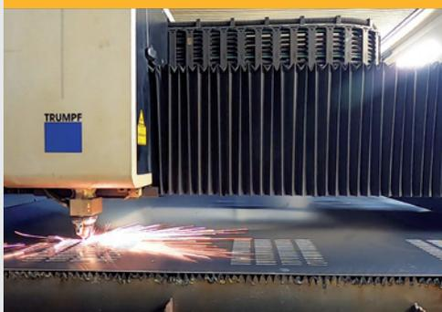
Unser automatisierter TruLaser 5040 gewährleistet komplexe Bearbeitungen bis 4.000 x 2.000 mm und steht für höchste Präzision in minimaler Zeit.
