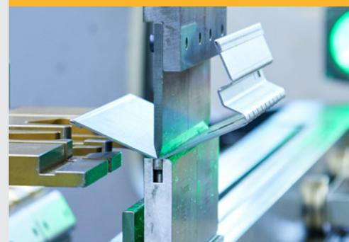
Als einer von wenigen Betrieben setzen wir auf das 3-Punkt-Biegeverfahren – für noch mehr Qualität und Genauigkeit bis 4 m Länge. Ebenso sind wir in der Lage Blechteile bis zu einer Länge von 2.540 mm in verschiedenen Materialstärken rund zu biegen.
